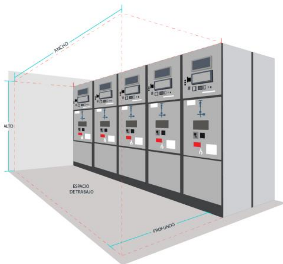
Ilustración 2. Espacios para montaje de equipos
